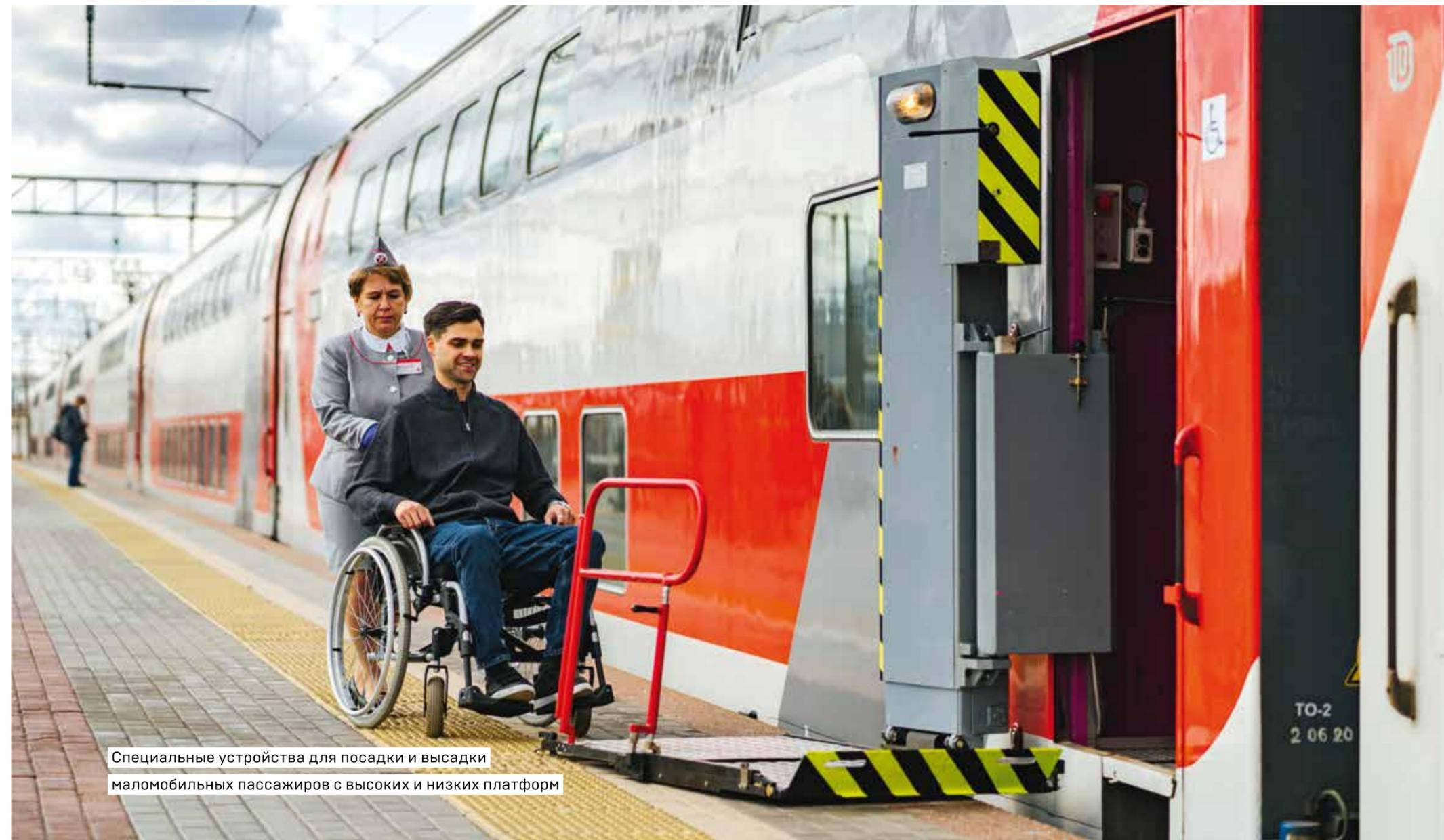
Специальные устройства для посадки и высадки маломобильных пассажиров с высоких и низких платформ
